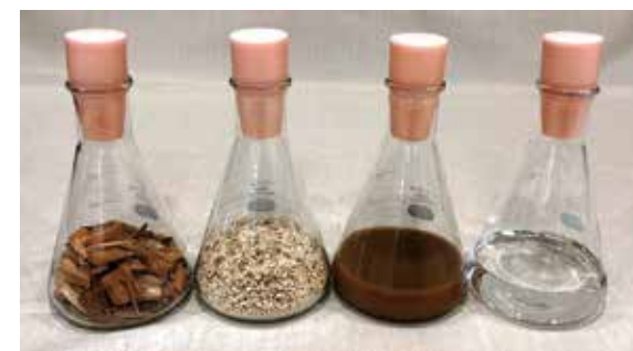
バイオエタノール製造過程(左から、チップ、パルプ、糖化発酵培養液、バイオエタノール)
