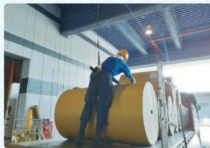
安全帯を使用した荷役作業
