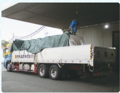
シート掛け作業
